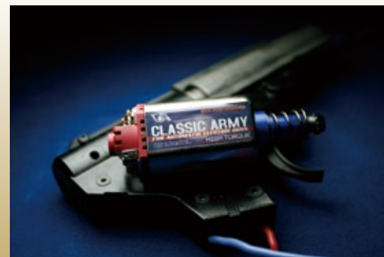
內部box呈現黑色外觀，採用了高扭力鋼製齒輪以及高扭力馬達，使用8.4V 800mach運動版電池即可下場。
