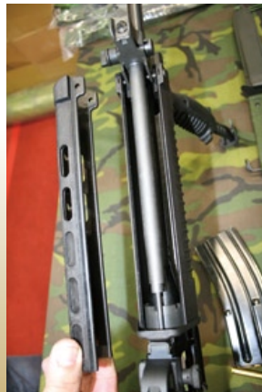
鳴威T-91除了槍枝的關鍵零組件之外，其他部分均仿實槍之製造過程，圖為打開上護木後的鍛造槍管結構。
