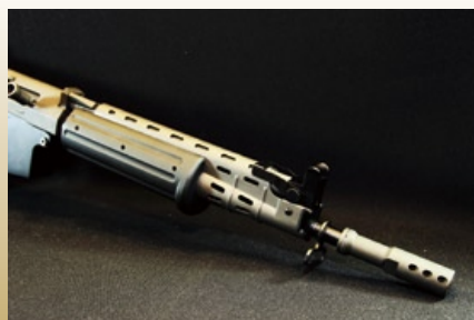
前段特寫，隨是短管版，該火帽是標準管版用的火帽，至於“Heat”片中的FNC是用類似M-16的鳥籠火帽。
