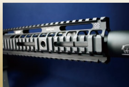
NOVESKE N4魚骨護木上散熱開孔特寫。
