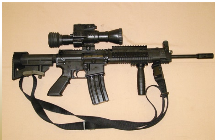
T-91是台灣陸軍新一代突擊步槍，圖為加裝TS84A星光夜視鏡、戰術握把和多功能背帶的特戰型T-91。
