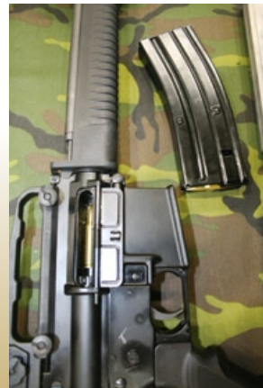
槍身上的拋殼口特寫，將訓練用子彈裝進彈匣後，拉動槍機即可忠實呈現有如真槍般的上彈和退殼動作。
