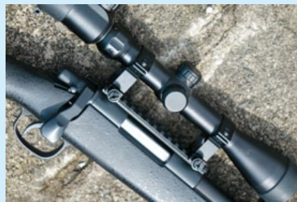
機匣上方裝有標準 M1913 導軌，可供安裝狙擊鏡。
