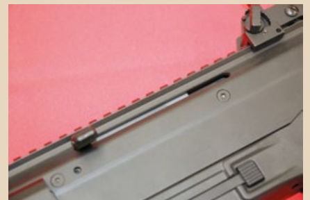
可變換左、右方向的槍機拉柄。
