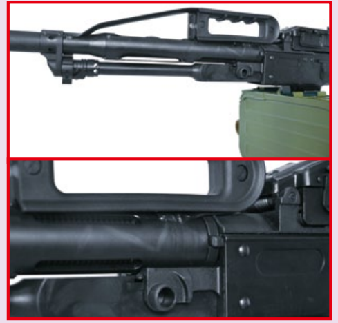
槍管上的金屬散熱套筒與上提把是最大特色。
