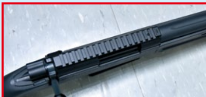
機匣頂部裝設全通式 M1913 戰術導軌，槍機拉柄也換成球形握把。
