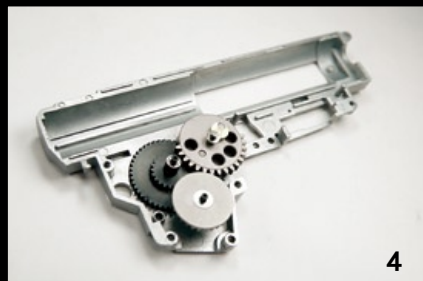
安裝齒輪於BOX上時，需注意齒輪間的關係與墊片厚度；這個步驟相當重要，因為這會影響運作的順暢度，同時也會牽動BOX的穩定性與壽命之長短。
