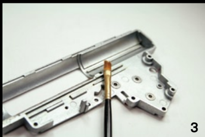
將BOX的溝槽上均勻塗上薄油，務必使活塞、拉桿等機件在BOX內運作順暢。
