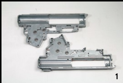
BOX採用Tokyo Marui的BOX來加工，安裝LayLax 7mm滾珠培林，安裝時須留意準位與BOX邊框的修正。
