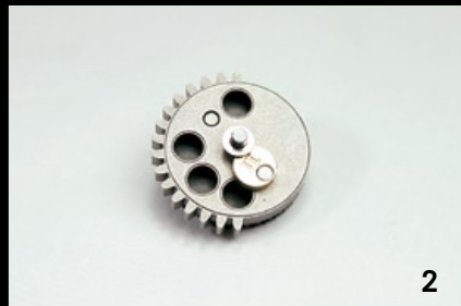
採用LayLax 2倍扭力齒，並在1號齒上安裝好上彈舵輪。
