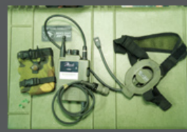
PRR馬可尼公司製H4855無線電，美陸戰隊編號為AN PRC-343。
