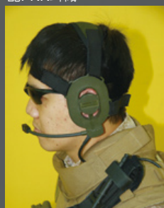
Selex公司的PRR，是一個小型收發雙通道無線電臺，為士兵提供短距離通信。
