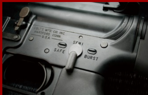
下機匣射擊選擇鈕特寫；注意經過硬化陽極處理的槍身所呈現出的像真質感。
