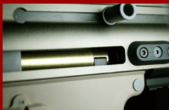
位於槍機最前端採不鏽鋼材質製作的推彈嘴。
