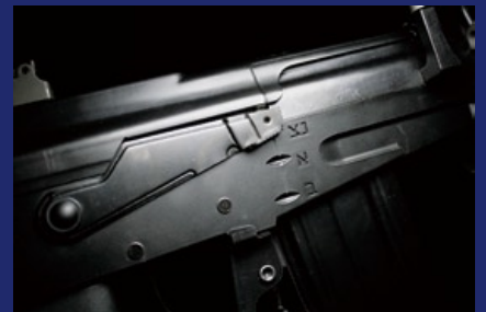
射擊選擇片與希伯來文的「保險-單發-連發」刻印。
