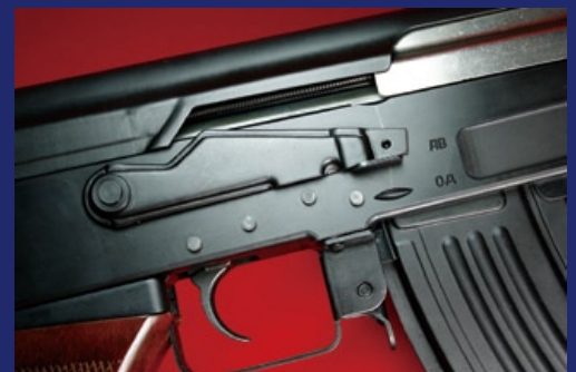
調節段數紮實、分明的射擊選擇片。
