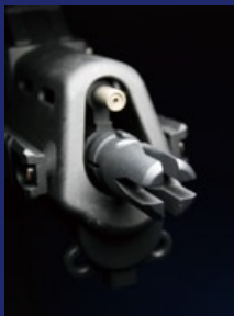
CA36C的鋼製四叉型防火帽特寫。
