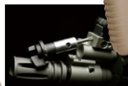
瓦斯活塞調節鈕可旋下，並當成簡易的拆槍工具(螺絲起)。
