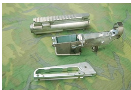
上、下槍身及提把均以CNC切削加工製成。
