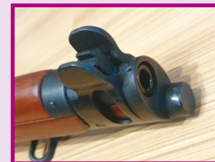
被包覆在準星座內的鋁合金槍管。
