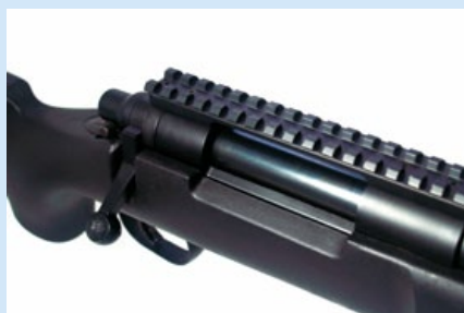
CNC車削的小型戰術軌道位於槍機拉柄上方，可跟狙擊鏡搭配使用。
