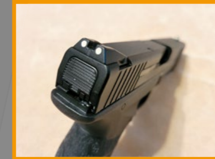
從暗處射擊也能輕鬆瞄準的夜光式照門。
